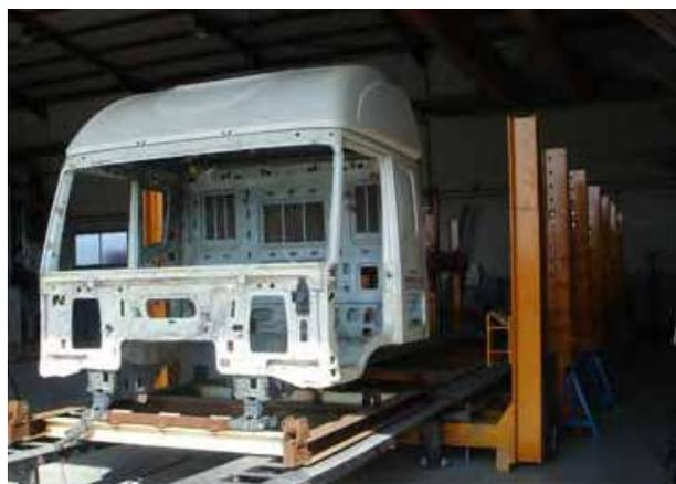
■ Cabina en soporte sobre una bancada de plataforma
