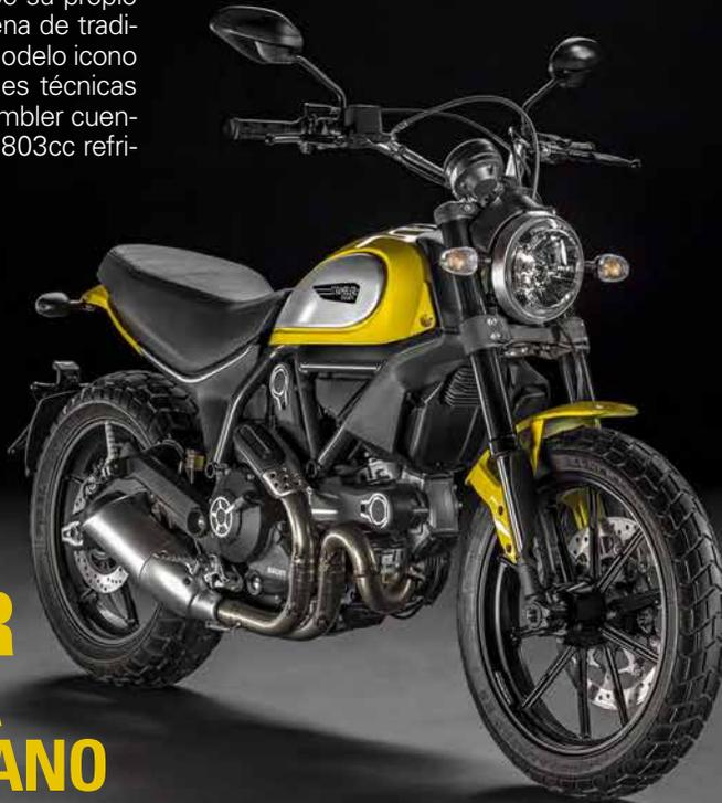
gerado por aire-aceite de 75cv a 8,250rpm con un par motor de 6.9kgm a 5,750 rpm. El sistema de suspensión Kayaba de la Ducati Scrambler incluye una horquilla invertida de 41mm y un monoamortiguador trasero con ajuste de precarga. Ambos ofrecen 150mm de recorrido, que junto con los neumáticos, facilitan la ruta por donde quiera que transcurra el camino. A su vez, lo complementa un sistema Brembo y un ABS Bosch 9.1 MP AMS para lograr un rendimiento en frenada óptimo.
