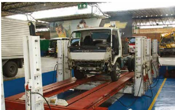
■ Proceso de reparación de un chasis mediano
