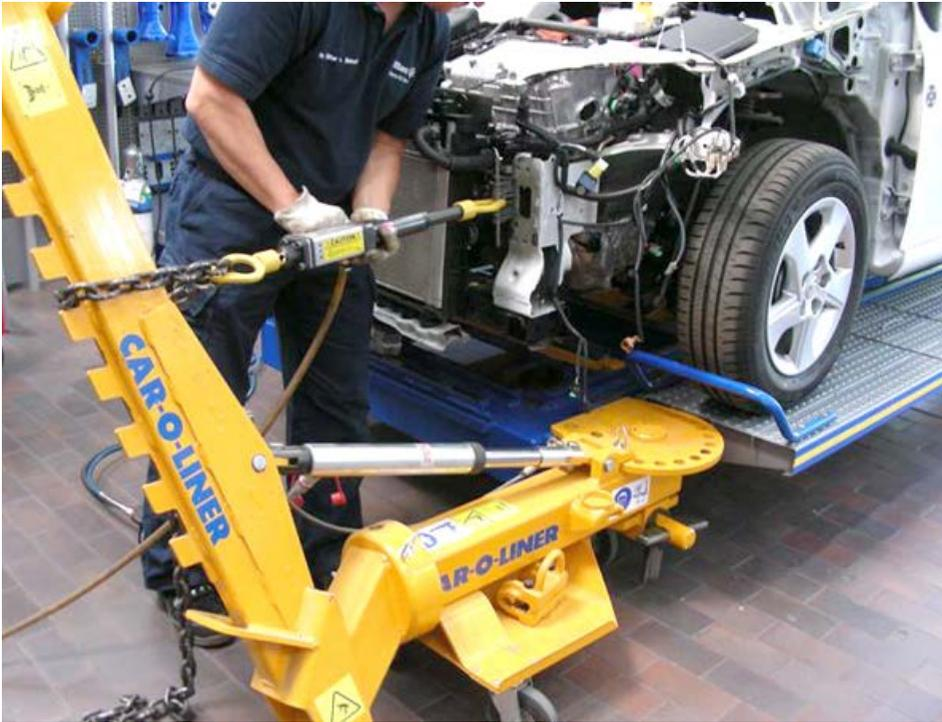
■ Proceso de reparación del chasis en vehículos eléctricos.
