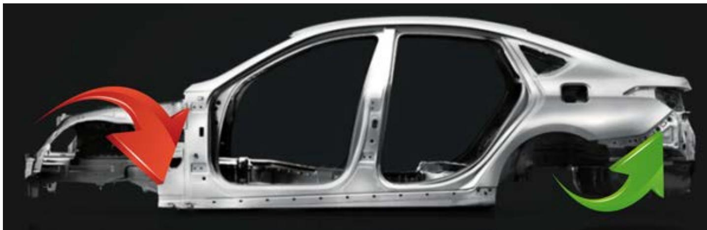
■ Cuando el acero no es lo suficientemente rígido, se producen ruidos por torsión de la estructura
