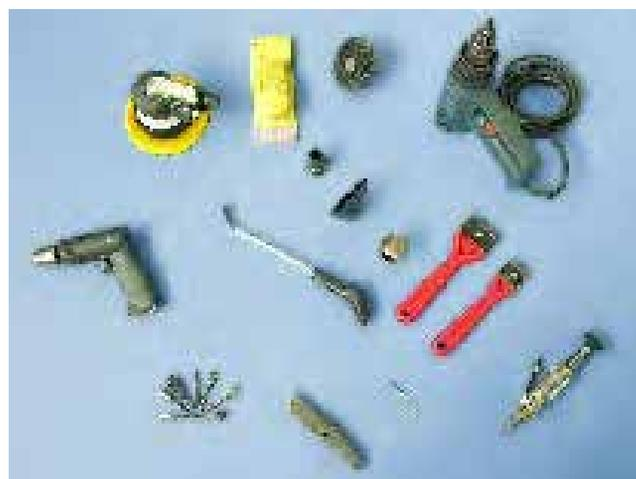
■ Herramientas utilizadas en la reparación de plásticos
