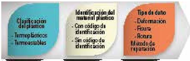
Como tal, los plásticos se clasifican en dos tipos: termoplásticos y termoestables. Los primeros se identifican porque se reblandecen y fluyen con la presencia de calor, permiten conformarse o moldear cuando se aplica calor directamente (al enfriarse se endurecen) y admiten la soldadura homogénea como método de reparación, es decir con el mismo material de aporte.
