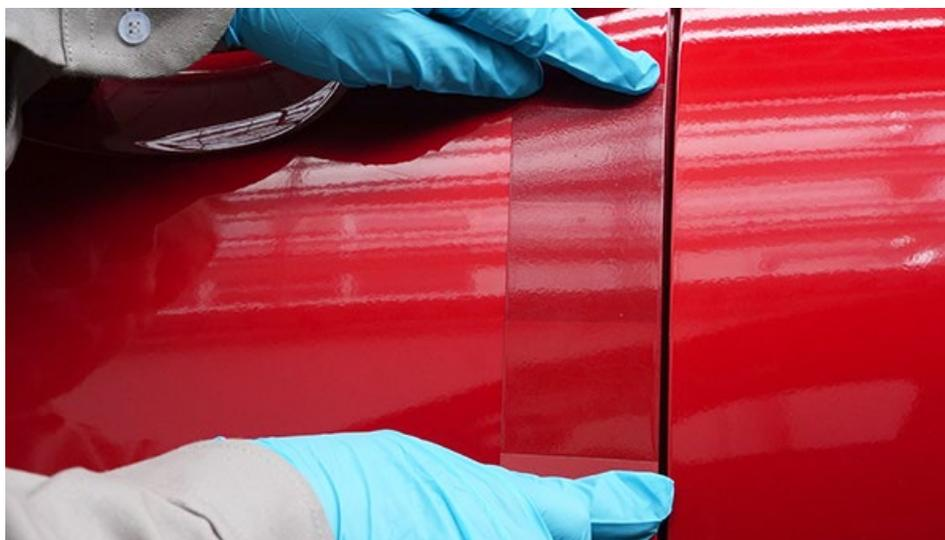
■ Comparación de color con probeta de prueba sobre el vehículo
