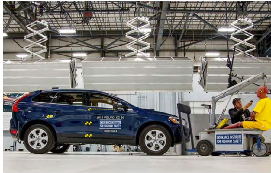
■ En los ensayos a baja velocidad se identifica cómo trabajan tanto los sensores, como los sistemas de frenado autónomo.
