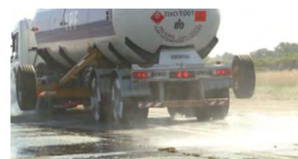
■ Tanque cilíndrico 1+1 doble rueda
