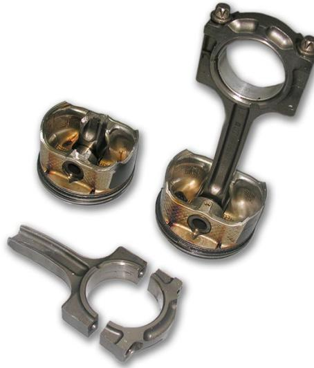
■ Bielas de motor deterioradas por el agua
