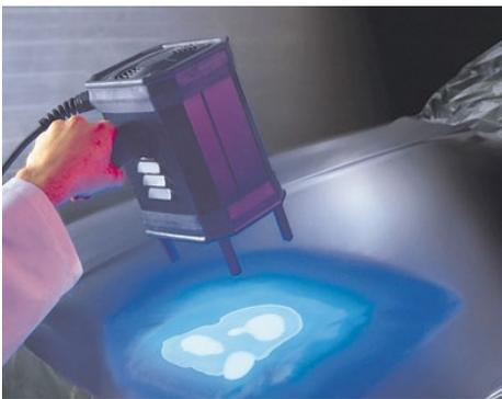
■ Secado por radiación ultravioleta
