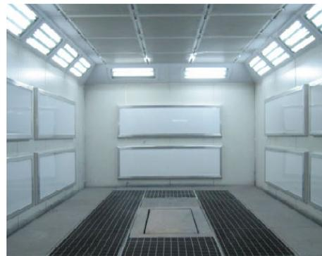
■ Paneles endotérmicos instalados en la cabina
