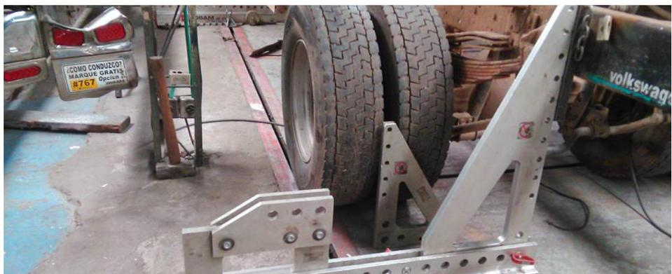
■ Foto 7: elementos de empuje en bancada piso para enderezado de chasis
