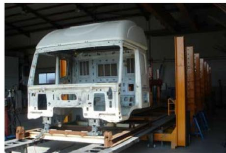
■ Foto 9: cabina en soporte sobre una bancada de plataforma
