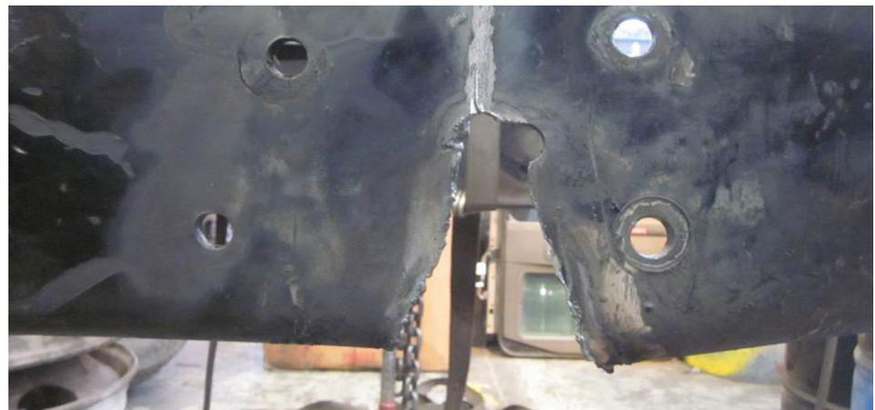
■ Foto 2: proceso de corte con equipo de oxiacetileno
