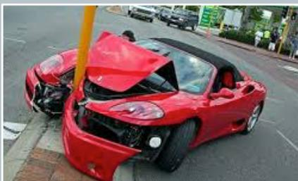
Colisiones en las que hay deformaciones extremas localizadas en una zona frontal del vehículo. En el caso puntal de un choque contra un poste.
