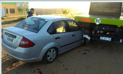
Colisiones en las que el impacto es gradual. Esto suele suceder cuando el impacto es contra la parte trasera de un camión, debido a que los sensores del vehículo no detectan altas desaceleraciones del choque.
