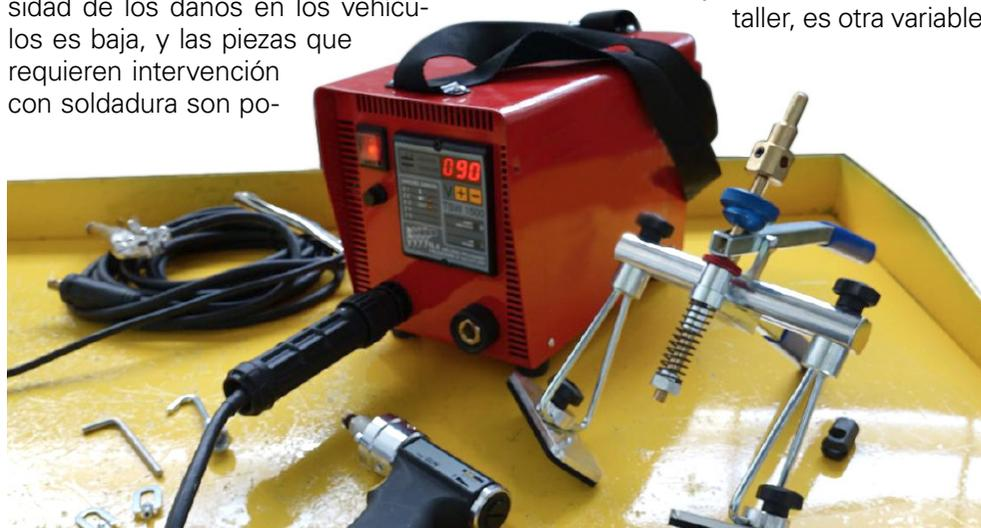
■ Equipo de soldadura inverter SPOTTER TECNA TSW 1500
