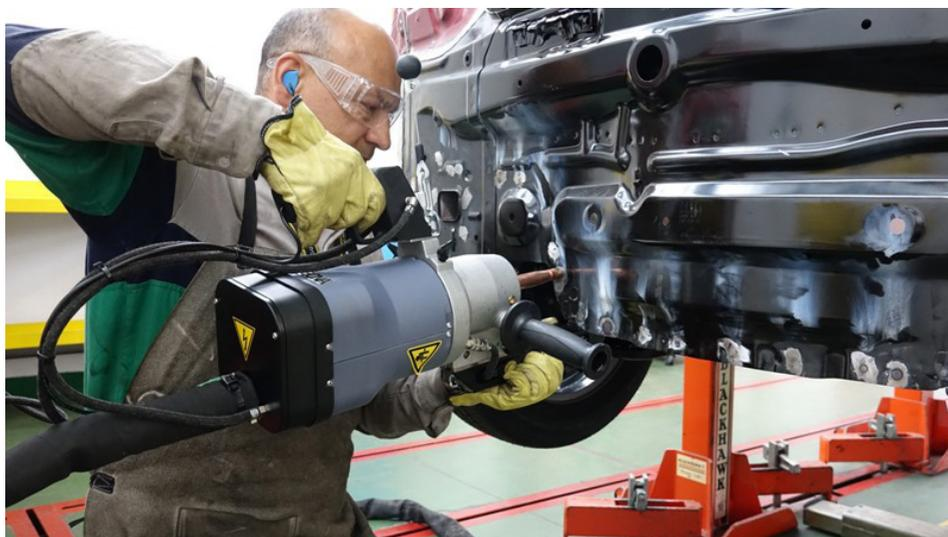
■ Equipo para soldadura por puntos de resistencia
