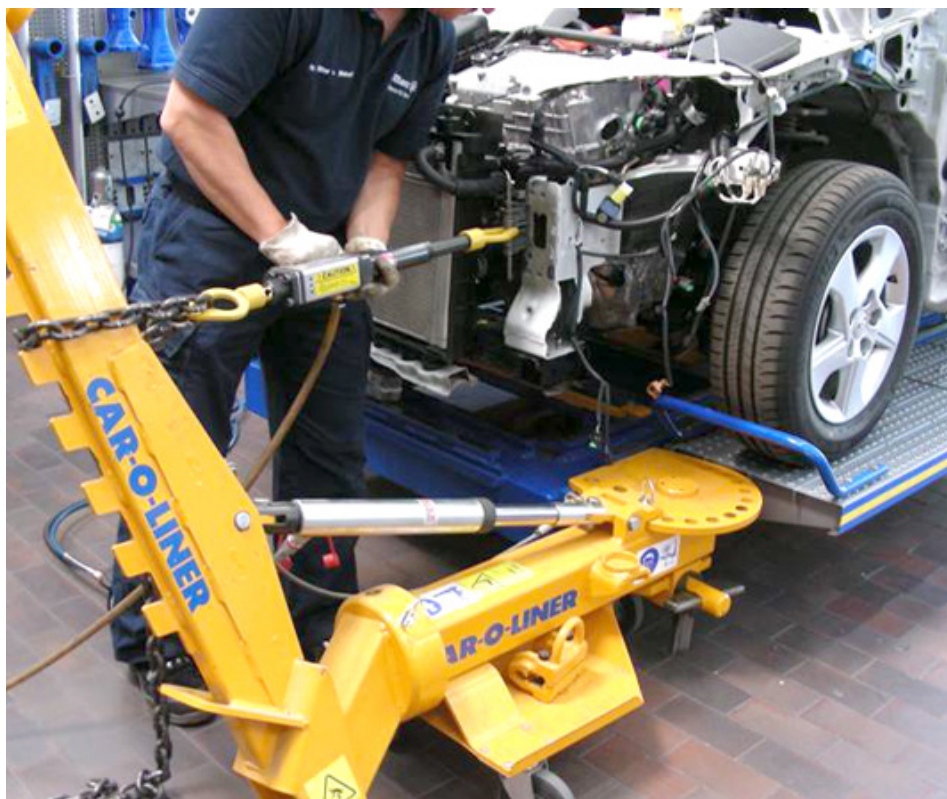
■ Proceso de reparación del chasis en vehículos eléctricos.
