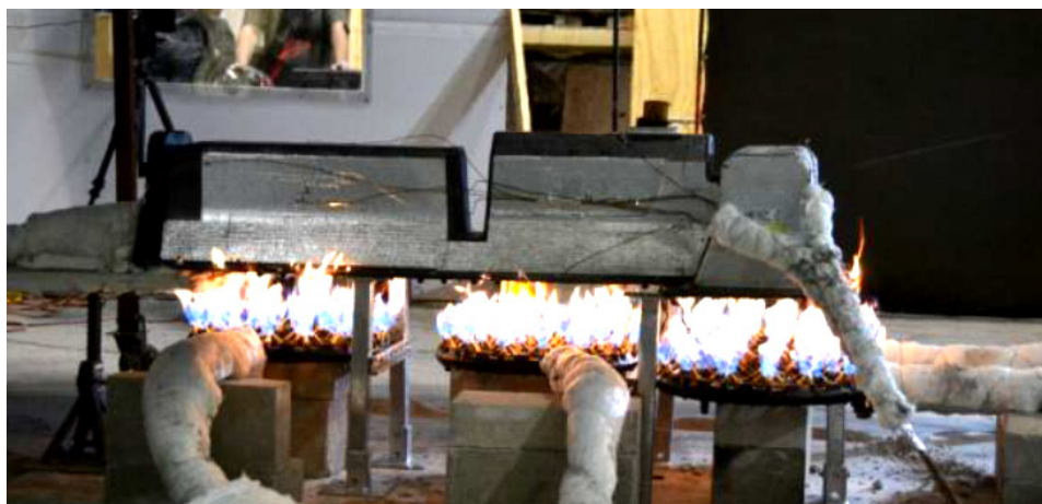
■ Inicio de prueba de conflagración de batería de iones de litio vehículo Chevrolet-Volt, bajo la normativa HRR
