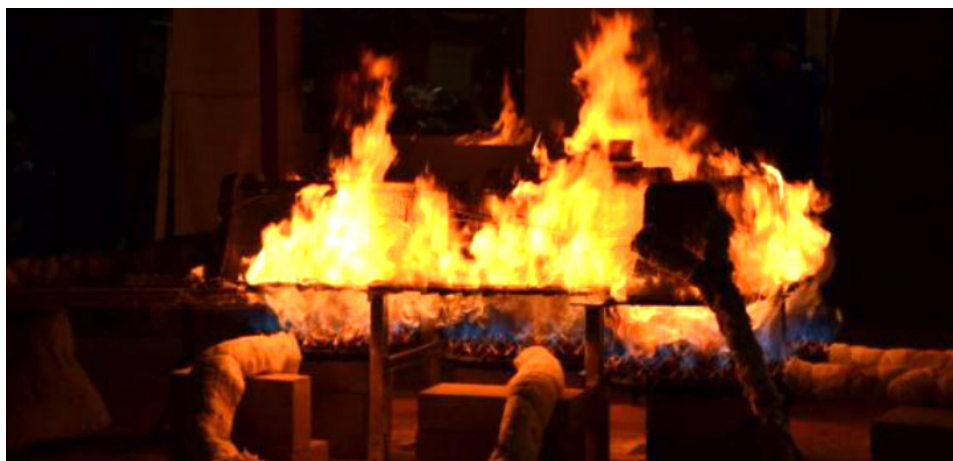
■ Conflagración total, batería de iones de litio vehículo Chevrolet-Volt, bajo la norma HRR
