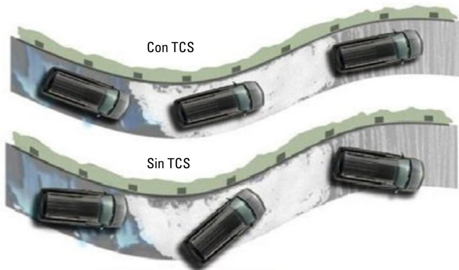
■ Diferencia entre conducir con Control de Tracción (TCS) y sin TCS en superficie irregular
