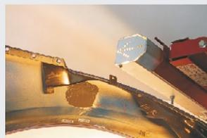
6 - Deje secar durante 15 min. o acelere la cura con lampara o pistola de calor
