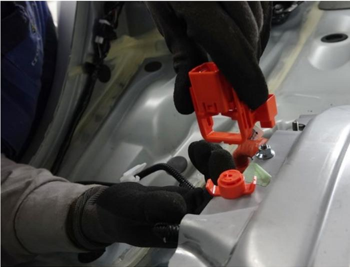
■ Desconexión de batería Toyota Corolla híbrido
