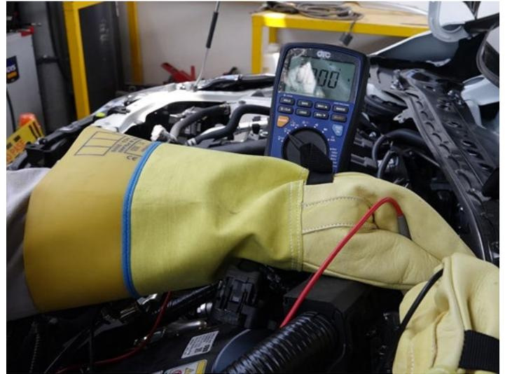
■ Medición de voltaje de la batería
