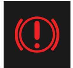
Freno de estacionamiento puesto o falla en el sistema de frenos cuando el vehículo está en movimiento
