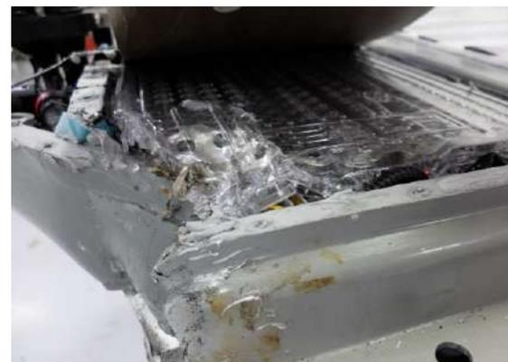
Así mismo, hubo consenso en que se hace necesario establecer parámetros mínimos para mejorar la poca distancia al suelo de los vehículos eléctricos y la falta de una cubierta protectora para el paquete de baterías en muchos vehículos debido a que mientras el promedio de altura de despeje de las SUV convencionales está entre 25 y 28 cm, las SUV EV tienen apenas de 16,5 a 17,5 cm, lo cual aumenta la exposición al riesgo.
